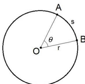
**Figura 07.** Ilustração que permite relacionar as variáveis da equação  $s = r\theta$
