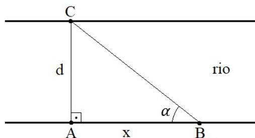
**Figura 01.** Ilustração para medir a largura de um rio
